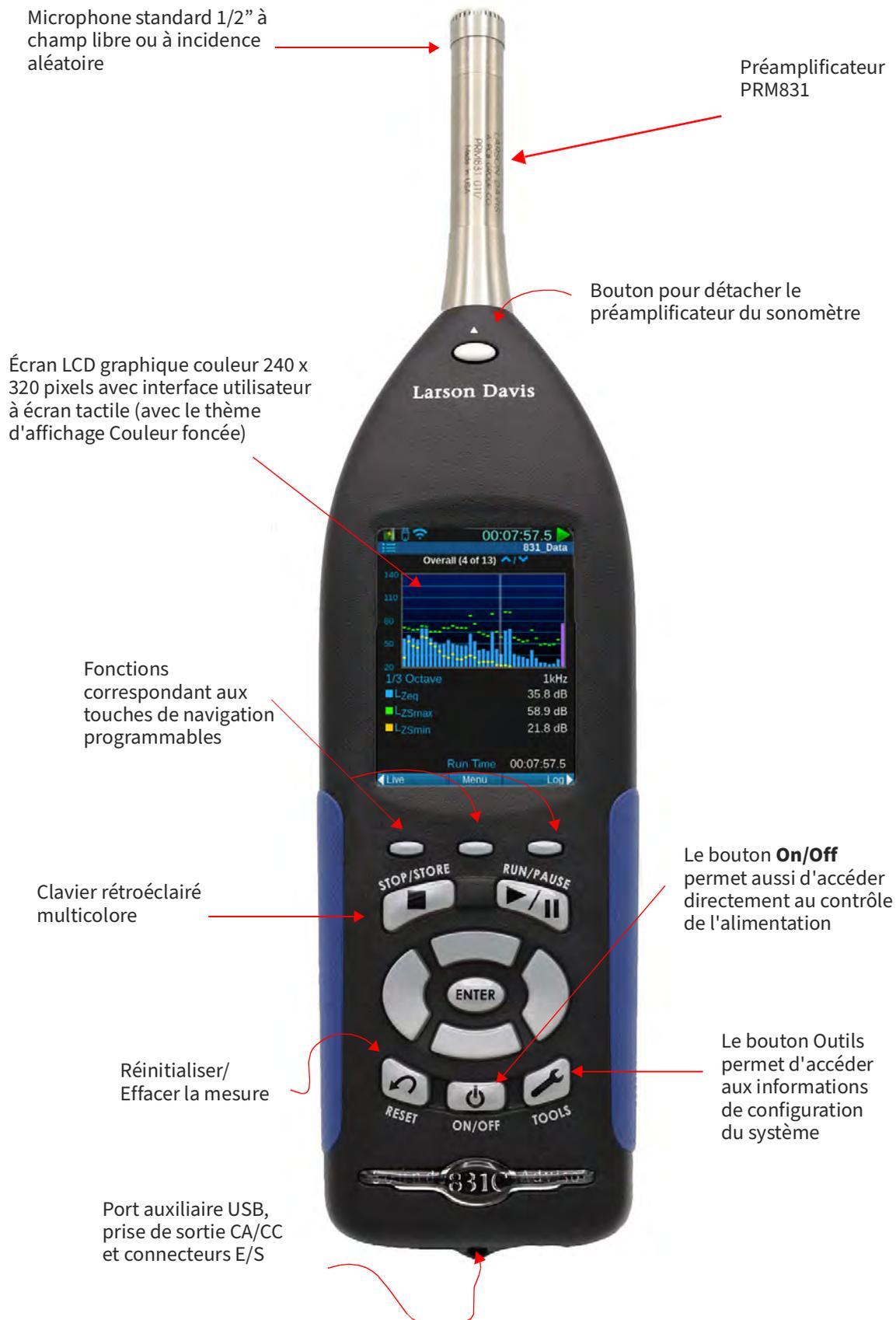
**FIGURE 2-2** Matériel de l'instrument
