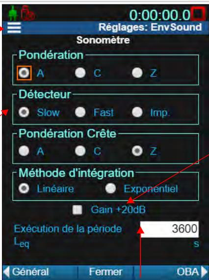
Cochez la case **Gain de 20 dB** lorsque vous mesurez des sons de faible niveau ou lorsque le niveau acoustique est proche du niveau du bruit de fond.
