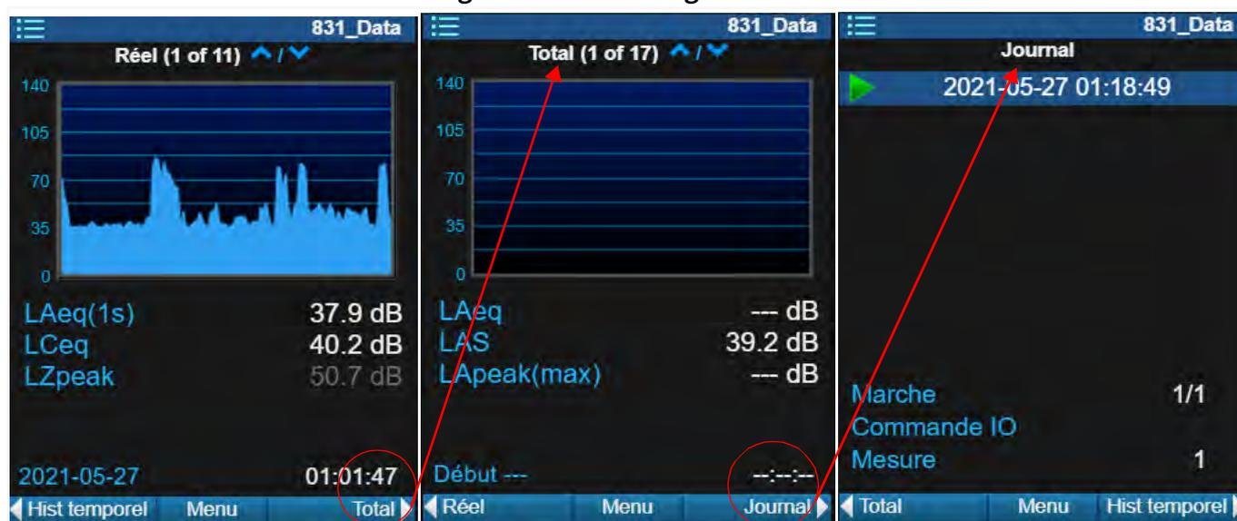
**Onglet Réel** : Étant donné que l'onglet Réel affiche en temps réel les valeurs mesurées par le sonomètre, cette page ne peut être commandée par le bouton (EXÉCUTER/INTERROMPRE) . Vous pouvez ainsi visualiser le niveau de pression acoustique actuel sans interrompre la mesure. Vous pouvez activer et afficher jusqu'à 13 pages de données Réel.
