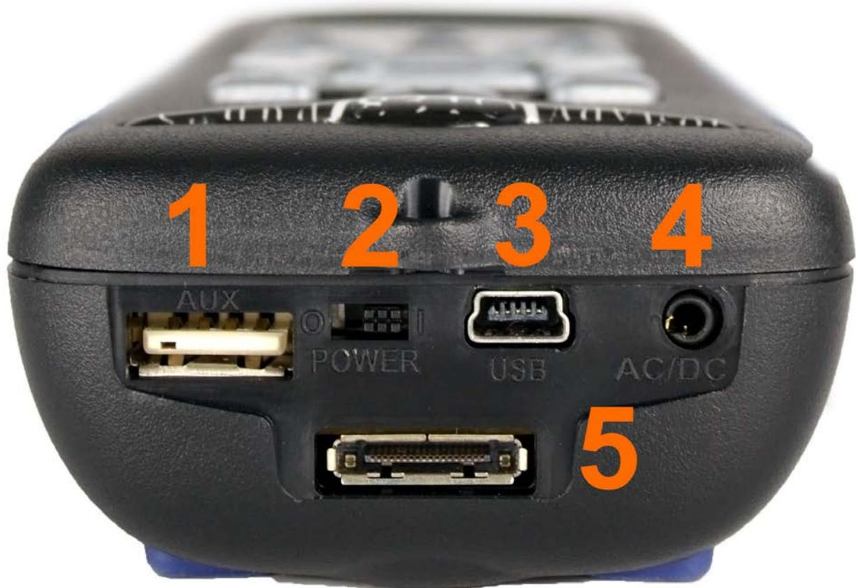
**WARNUNG** Verwenden Sie zum Ein- und Ausschalten des SoundAdvisors NICHT den Hardware-Stromschalter. Das kann zum Verlust von Daten führen. Dieser Schalter dient dem Trennen der Batterien für die Lagerung (1 bis 2 Wochen). Für längere Lagerung die Batterien aus dem Messgerät entfernen.
