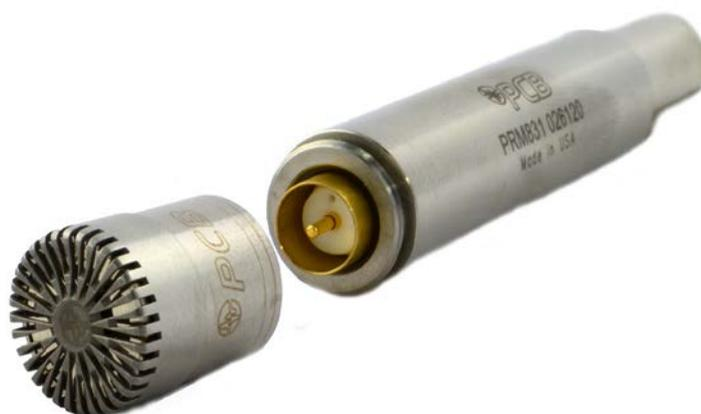
Setzen Sie die Unterseite des Mikrofons vorsichtig auf die Oberseite des Vorverstärkers. Schrauben Sie die Gruppe leicht zusammen. Das Mikrofon lässt sich problemlos am Vorverstärker anbringen. Zum Entfernen des Mikrofons fassen Sie den Mikrofonkorpus locker an den beiden eingravierten Linien und drehen Sie es.
