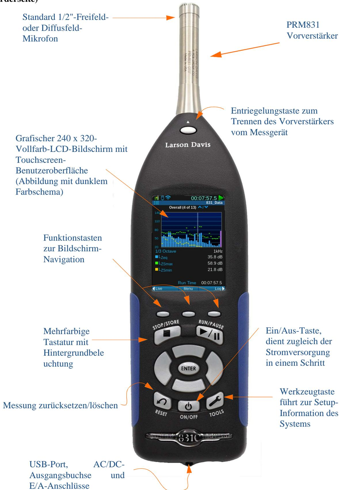
ABBILDUNG 2-2 Instrument - Übersicht (Unterseite)
