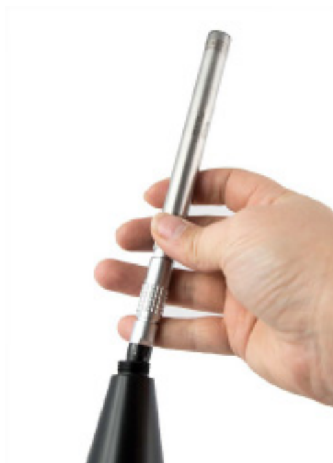
FIGURE 2-9 Tirer délicatement pour extraire l'ensemble
