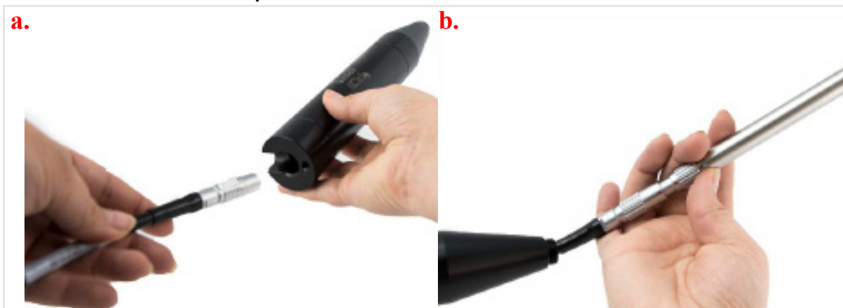
FIGURE 2-14 Insérer le câble, connecter l'ensemble préamplificateur / microphone
