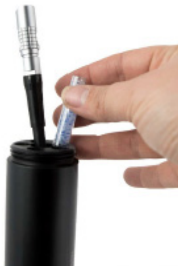
FIGURE 2-10 Remplacer les capsules de déshumidificateur
