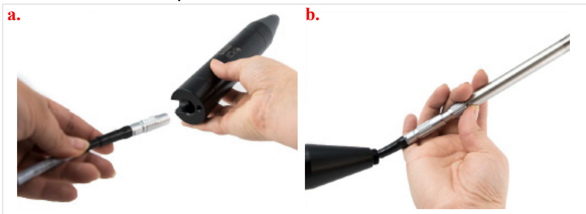
FIGURE 1-3 Insérer le câble, connecter l'ensemble préamplificateur / microphone
